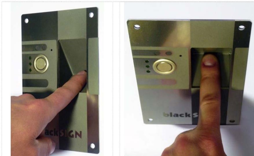
Figura 3.1.1 CORECT – Degetul este drept, asezat pe toata suprafata senzorului;
