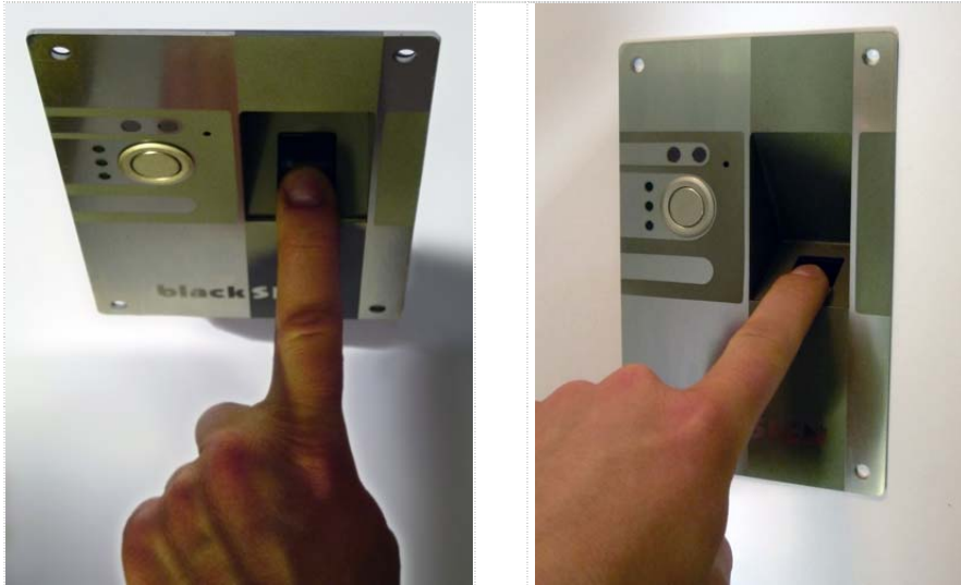
Figura 3.1.4 INCORECT – Degetul nu este asezat pe toata suprafata senzorului (prea retras);
